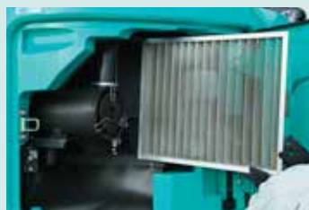
iNDR-Filter / Kühlmittelbehälter / Luftfilter
