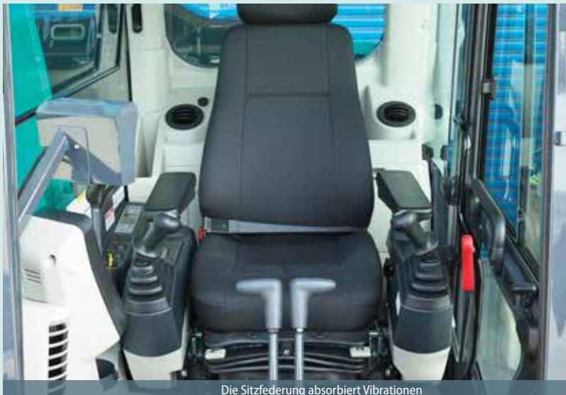
Die Sitzfederung absorbiert Vibrationen
