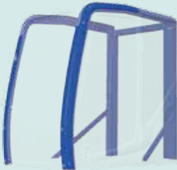
Dach-Schutzgitter Stufe II (erfüllt ISO10262)
