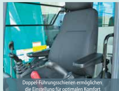
Die Sitzfederung absorbiert Vibrationen
