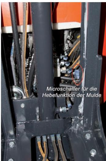
Microschalter für die Hebefunktion der Mulde
