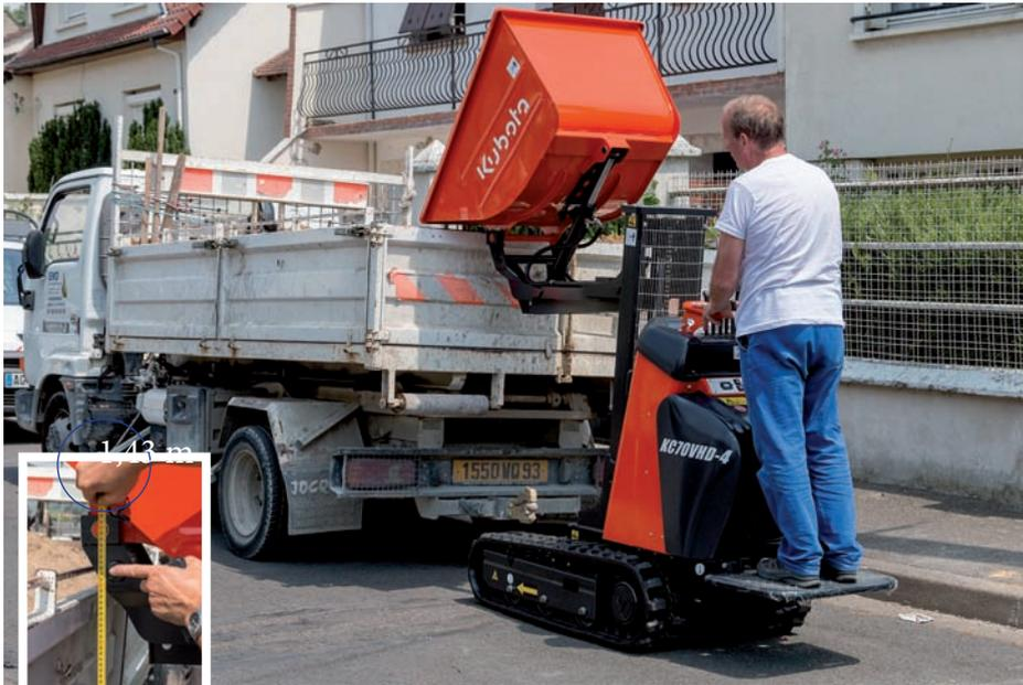
Muldenauskipphöhe auf Bolzen - Drehpunkthöhe
