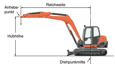
\* Die technischen Daten über den Arbeitsbereich der Maschine wurden mit dem Kubota Standard - Tieflöffel ermittelt, ohne Schnellwechseinrichtung.
