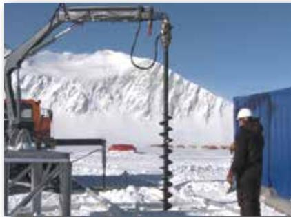
**Erdbohrer mit Bohrschnecke
