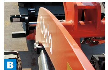
B Sicht auf die Schnellwechsler-Verriegelungsbolzen
