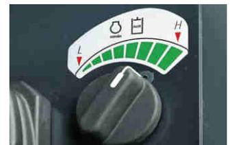
Motordrehzahl - Regler (Zusatzkreis Hydraulikölfluß) Der Drehregler ist zwischen: 1050 - 2400 U/min einstellbar (Nur im ATT bzw. Zubehör - Modus).
