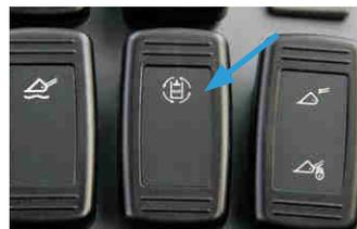
Zusatzsteuerkreis Konstantsschalter: Ein einfacher Druck auf den Zusatzkreis Schalter und die eingestellte Hydraulikölmenge bleibt bei allen Modus - Stufen gleich.
