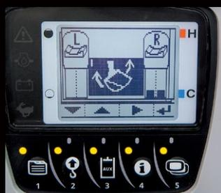
Max. Hydraulikölmengen – Einstellung (SP1 und SP2)
