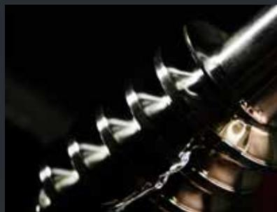
Ölgefülltes Rotorgehäuse. Im Unterschied zu Fett leitet Öl die Reibungswärme beim im Zahnkontakt gleitenden Schneckengetriebe ab.
