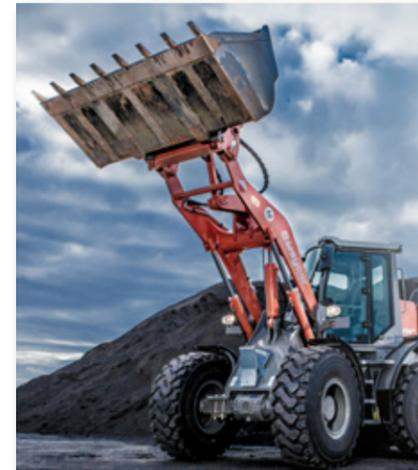
Zum Beispiel der AR250e, ein Radlader der 2,5-Kubikmeter-Klasse, der über einen 6-Zylinder-Motor mit starken 218 PS verfügt. Die in Deutschland entwickelte und gebaute Maschine überzeugt durch Effizienz und Ergonomie. Ungeteilte Scheiben und die schmale Lenksäule ermöglichen eine einzigartig freie Rundum-Sicht. Die Anordnung der Schalter wurde optimiert und die Anzeigen im Display auf das Wesentliche reduziert. Die
