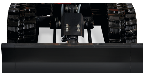
Understel på 840 mm når det er kørt ud – øget stabilitet
