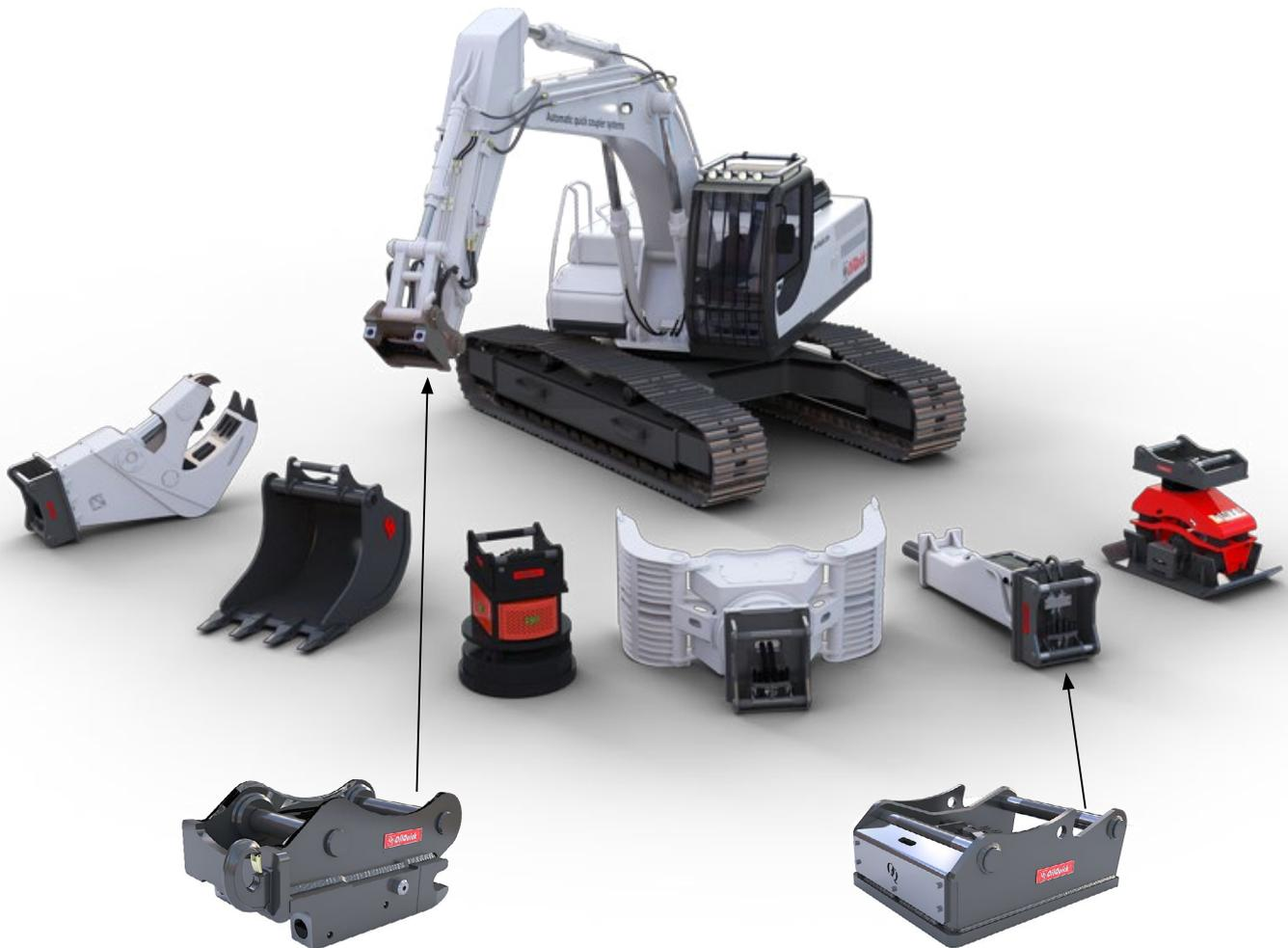
OilQuick Schnellwechsler mit Elektro- und Hydraulikkupplungen
