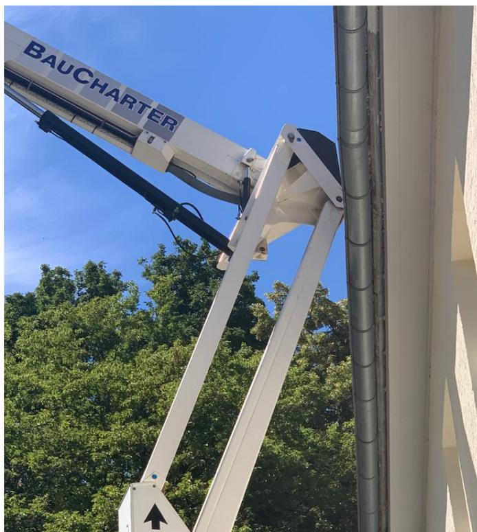
Der neue Bereich Höhenzugangstechnik umfasst mobile Bühnen auf Anhängern oder Fahrgestellen und selbstfahrende Modelle. Die modernen Hebebühnen stellen sich selbst auf, wobei die Anhängerbühnen eine Höhe von bis zu 15m erreichen. Die LKW-Bühnen sind für 7,49to Fahrgestelle ausgelegt und lassen sich bis zu einer Höhe von 25m ausfahren.
