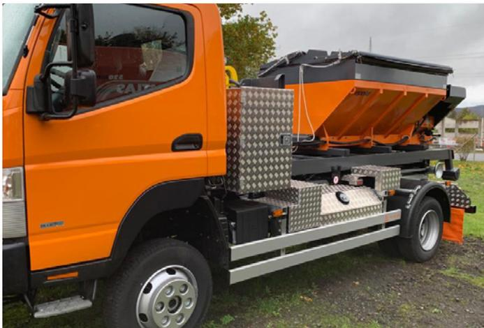
Mercedes Benz Fuso Fahrgestell mit Winterausrüstung von Epoke aus Osthessen
